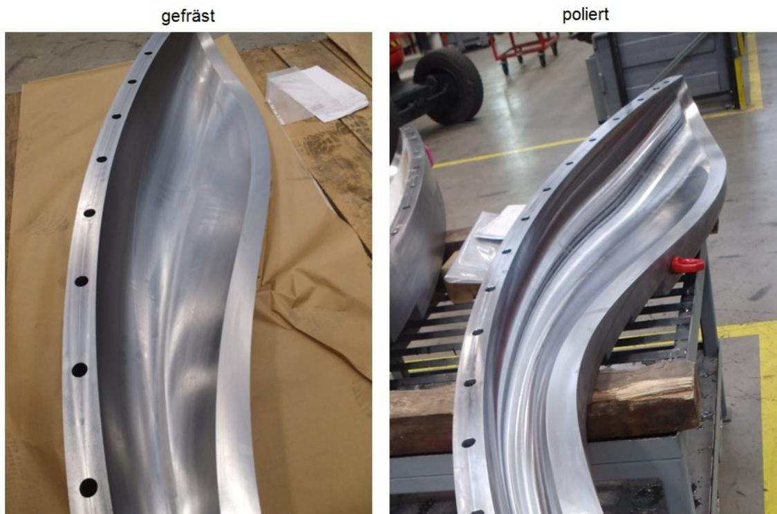
Abb. 58: Legevorrichtung des Laternenkopfes nach dem Fräsen bzw. Polieren, Quelle: Eigene Darstellung.
