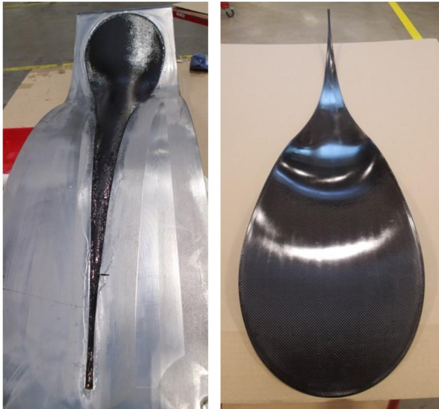
Abb. 60: Laminiertes Reflektor (links) und ausgehärtetes Bauteil (rechts), Quelle: Eigene Darstellung.
