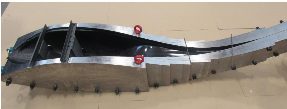
Abb. 62: Zusammengebaute Legevorrichtung des Laternenkopfes, Quelle: Eigene Darstellung.
