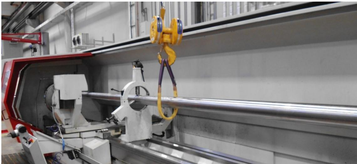
Abb. 49: Montage des zehnteiligen Wickeldorns, Quelle: Eigene Darstellung.
