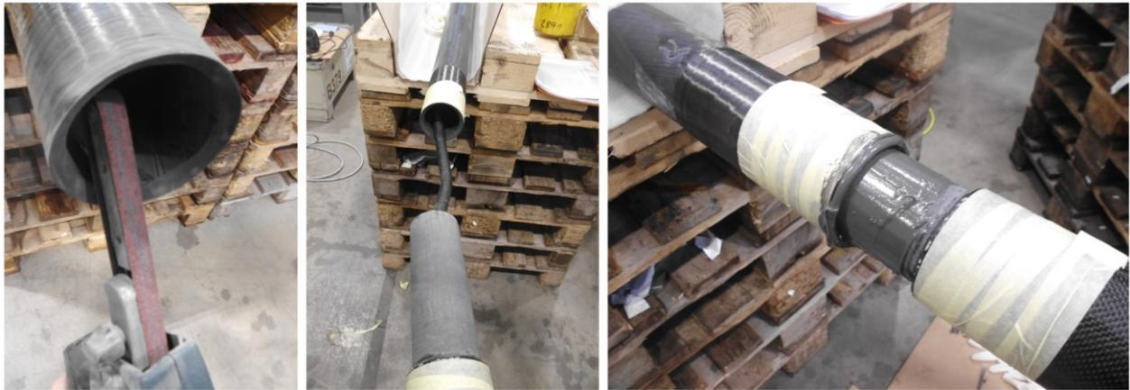
Abb. 64: Verklebung des Mastes mit dem Laternenkopf, Quelle: Eigene Darstellung.
