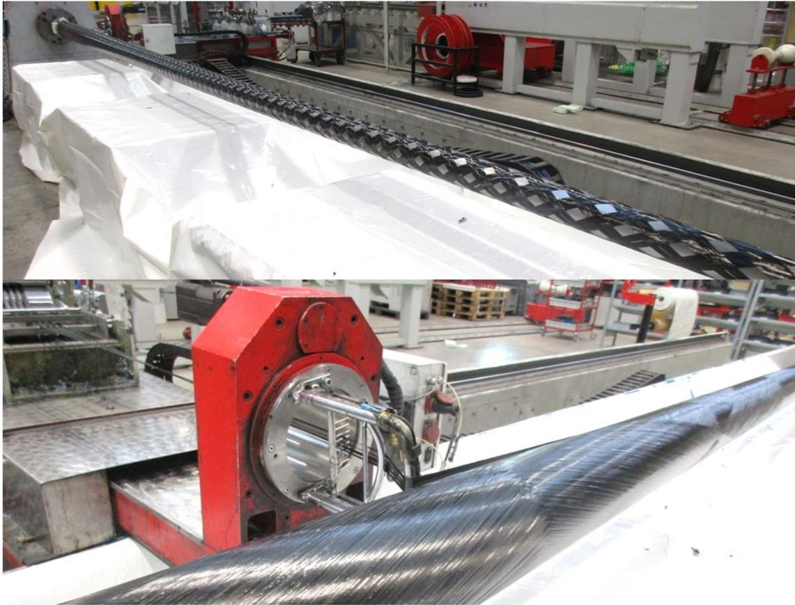
Abb. 52: Wickeln des Mastes, Quelle: Eigene Darstellung.
