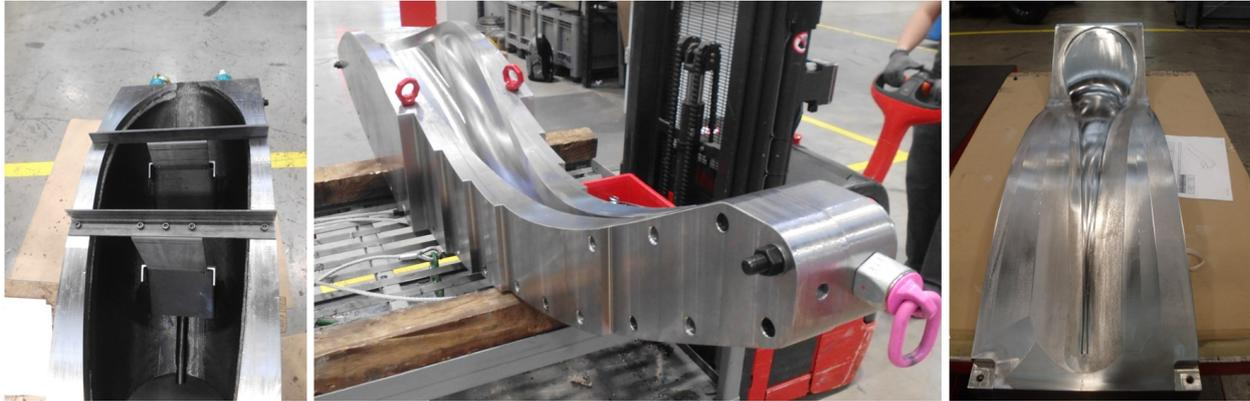
Abb. 59: Positioniervorrichtung (links), montierte Vorrichtung des Laternenkopfes (Mitte) und Vorrichtung des Reflektors (rechts),
