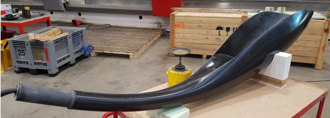
Abb. 63: Ausgehärteter Laternenkopf, Quelle: Eigene Darstellung.
