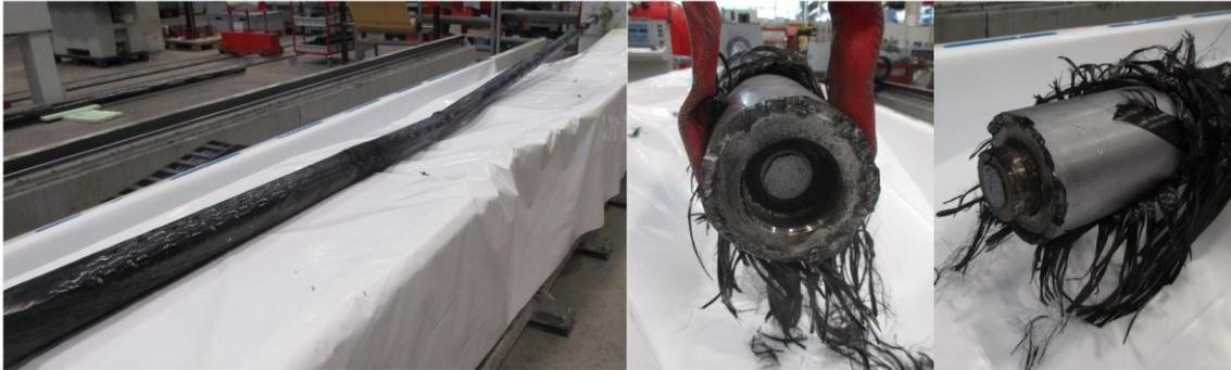
Abb. 50. Wickeldornbruch zwischen Teil 5 und 6, Quelle: Eigene Darstellung.
