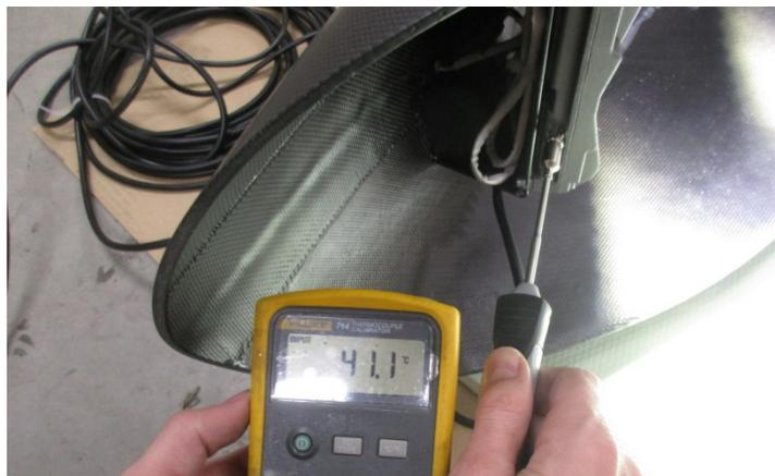
Abb. 68: Temperatur der Leuchtkörper im Dauerbetrieb, Quelle: Eigene Darstellung.
