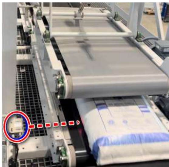
Abb. 23: Lichtschanke Sackvereinzlung, Quelle: Eigene Darstellung
