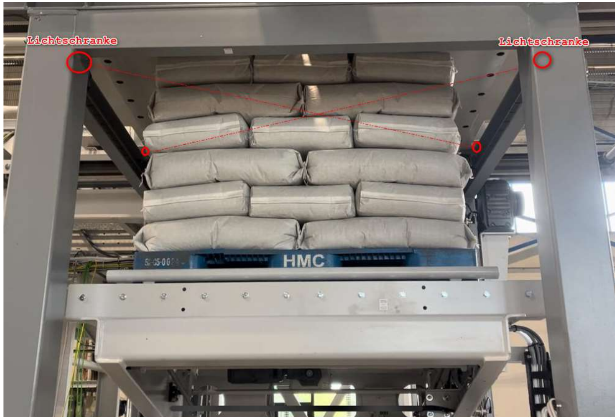
Abb. 36: Kreuzlichtschranke-Hubtisch, Quelle: Eigene Darstellung
