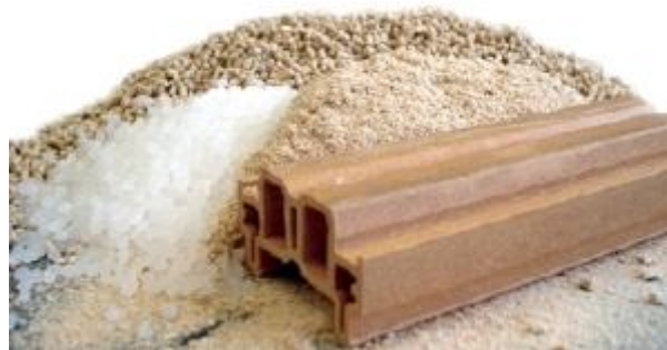
Abb. 31.: WPC-Granulat und extrudiertes WPC-Profil, Quelle: Pallmann Maschinenfabrik GmbH & Co. KG, Onlinequelle [11.11.2018].
