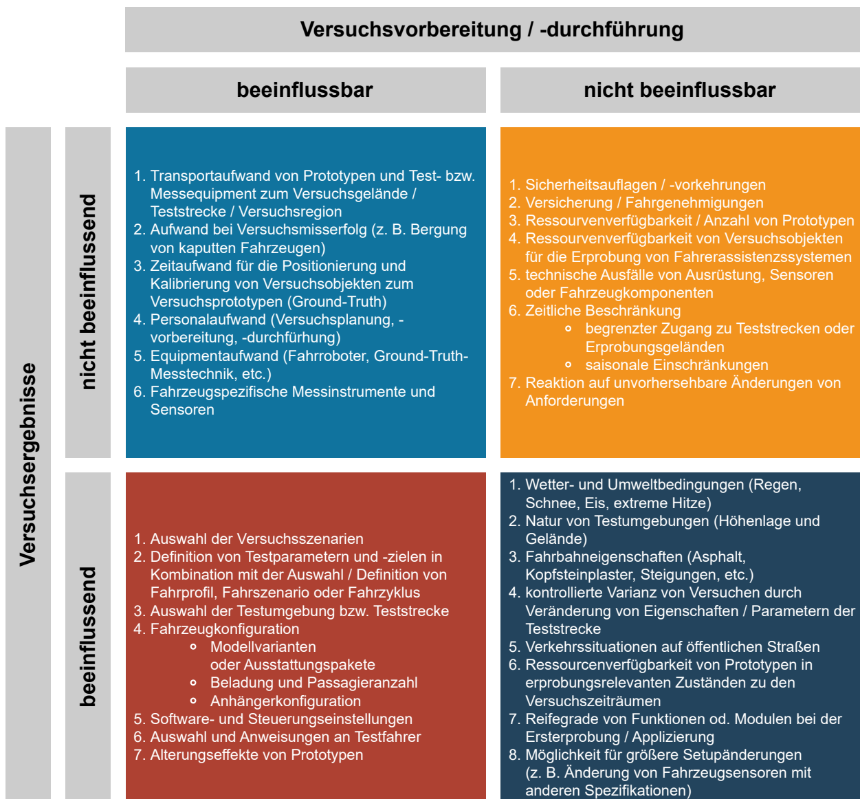
Abb. 3.6: Gliederung von relevanten Einflussfaktoren bei der realen Straßenerprobungsvorbereitung und -durchführung im Hinblick auf zu erzielenden Versuchsergebnisse, Quelle: Eigene Darstellung.
