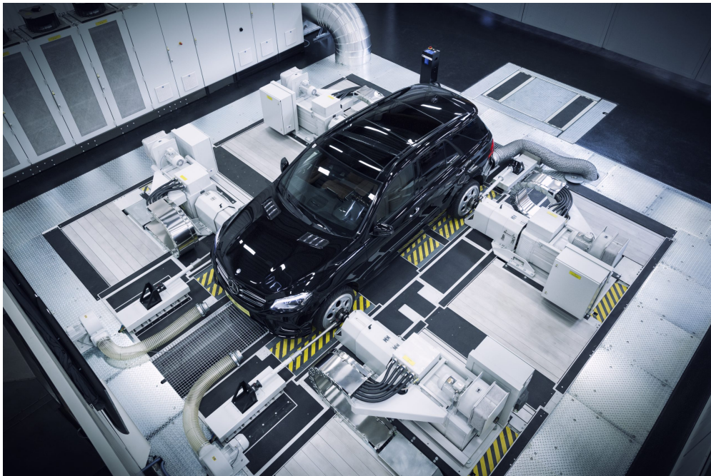
Abb. 4.6: Gesamtfahrzeug-Antriebsstrangprüfstand (KS-R2R), Quelle: Wirtschaftswelt (2021), Online-Quelle [15.10.2023].
