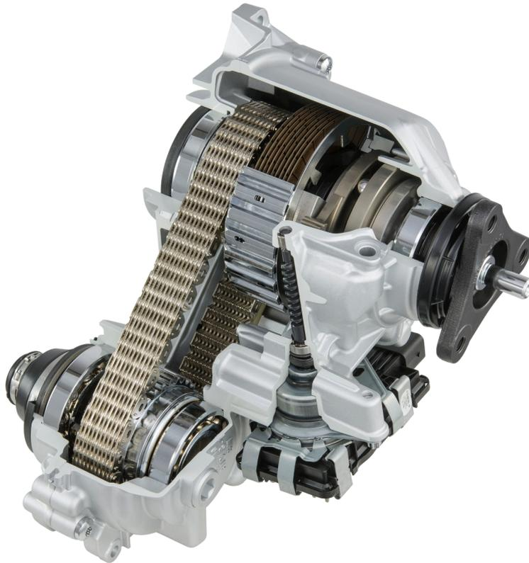
Abb. 31: Geschnittenes Verteilergetriebe der Magna Powertrain, Quelle: Magna intern
