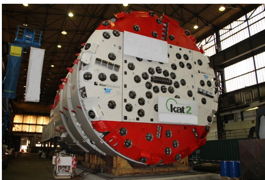
Abbildung 1 Aufnahme der Tunnelbohrmaschine für den Koralmtunnel zwischen der Steiermark und Kärnten von der Firma Geodata
