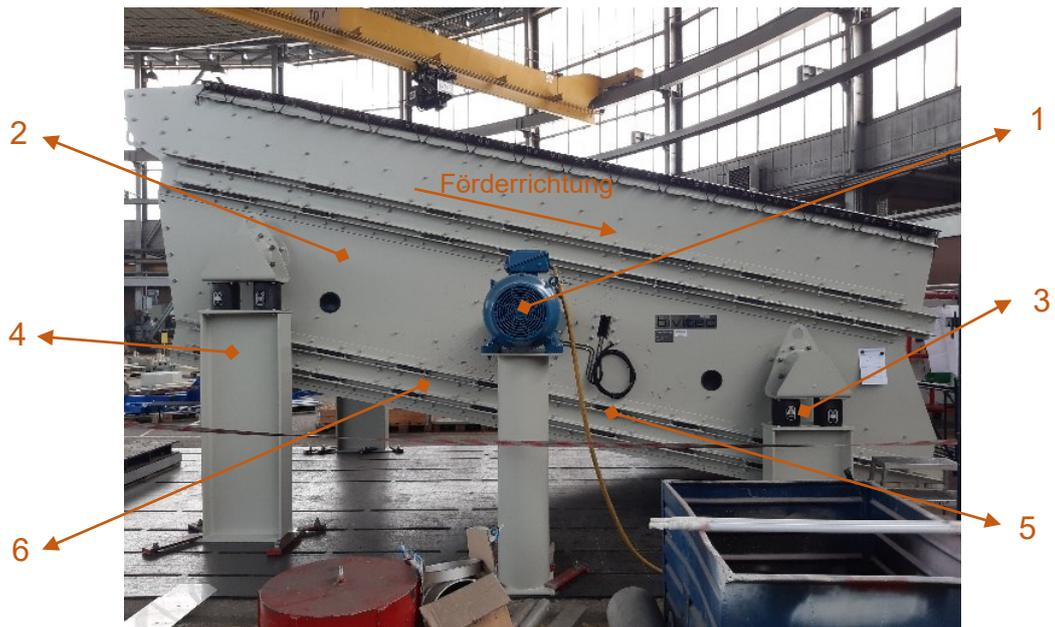
Abbildung 4: Siebmaschine Seitenansicht (rechts), Quelle: Binder+Co
