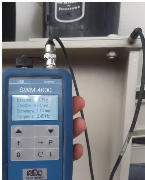
Abbildung 37: Messungen mittels mobilen Schwingweitenmessgeräts, Quelle: Eigene Darstellung
