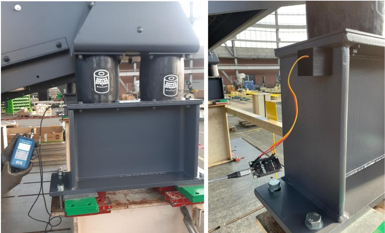
Abbildung 40: Links...Messung Reovib SWM 4000, rechts...Messung MPU-9250, Quelle: Eigene Darstellung
