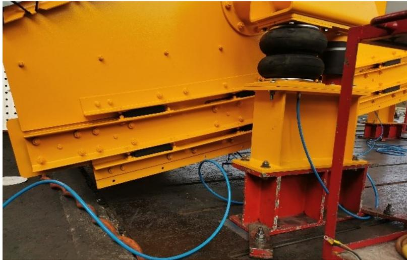
Abbildung 11: Notwendiger Einsatz weiterer Stützelemente (rot) zu den Originalstützen (orange), Quelle: Binder+Co
