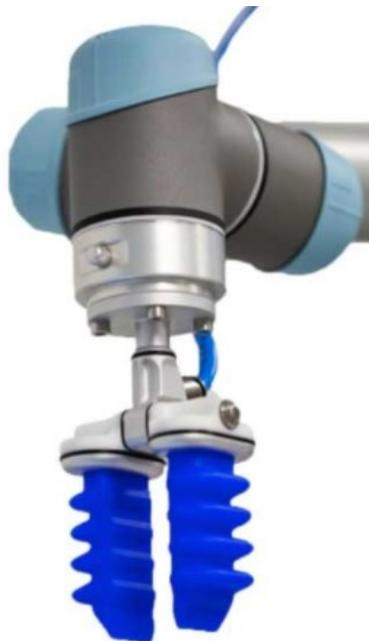
Abb. 50: Soft- Gripper am Cobot montiert, Quelle: Universal Robots A/S (2021), Online-Quelle [8.Oktober.2021].
