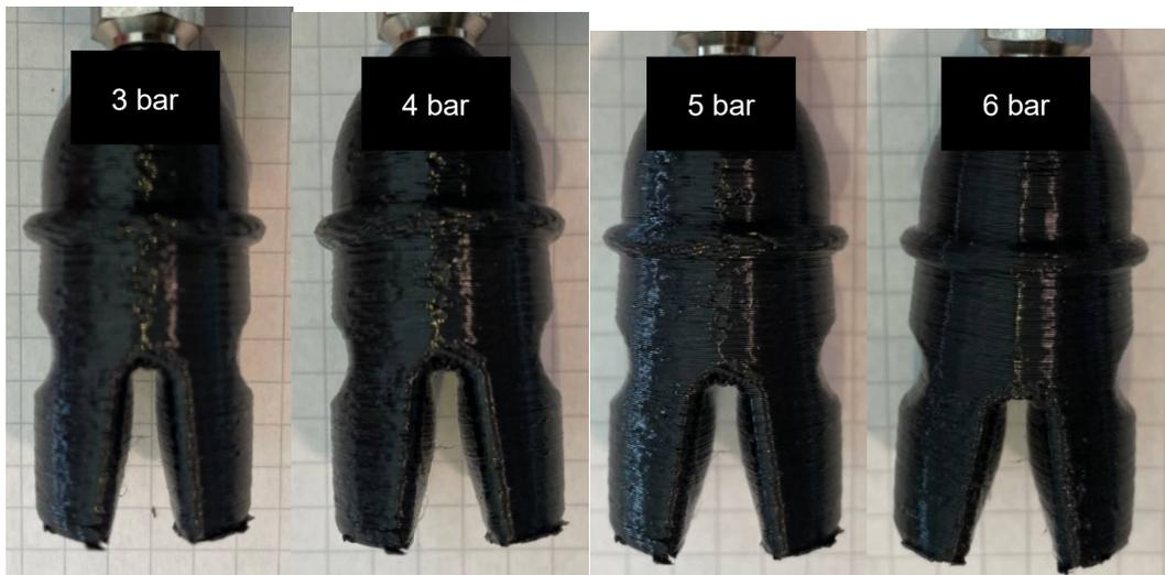
Abb. 80: Reale Verformung Soft- Robotic- Innengreifer (Versuch 2), Quelle: Eigene Darstellung.
