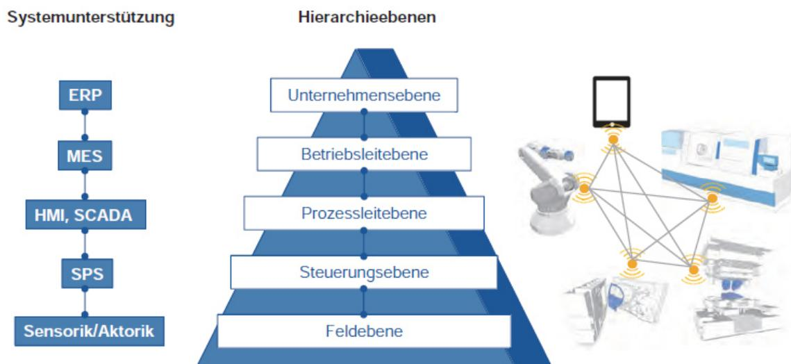
Abbildung 8: Vertikale Vernetzung – Automatisierungspyramide und Systemunterstützung, Quelle: Reinhart (2017), S. 18.
