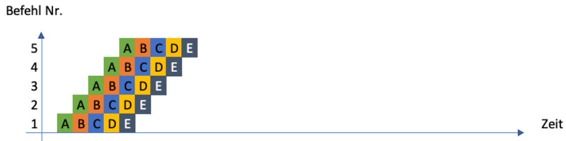
Abbildung 4-5: Befehlsverarbeitung mit Pipelining (in Anlehnung an „Pipeline (Prozessor)“, 2021)
