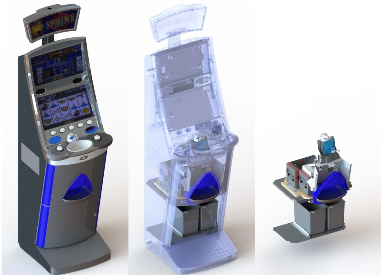
Abbildung 2: Automatisiertes Münzverarbeitungssystem im Spielautomatenmodell delite™, Quelle: Eigene Darstellung.
