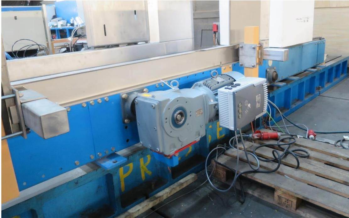
Abbildung 27: Beispiel eines Testaufbaus mit NORD FUs, Quelle: Andritz.
