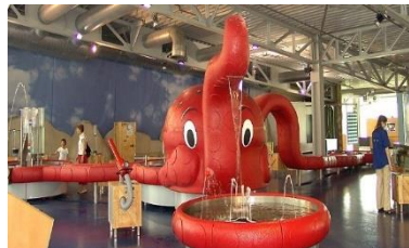
Abbildung 29: Octopus-Großplastik aus Hartschaumbeschichtung mit rot eingefärbten PUR-Elastomer, Quelle: Kastner Produktgestaltung GmbH.
