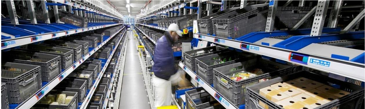
Abb. 27: Pick-by-Light in einem Kommissioniersystem, Quelle: Wibond Pick-by-Light (2020), Online-Quelle [26.10.2020]
