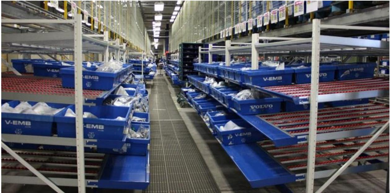
Abb. 24: Durchlaufregal, Quelle: Dexion Durchlaufregale (2020), Online-Quelle [13.09.2020]
