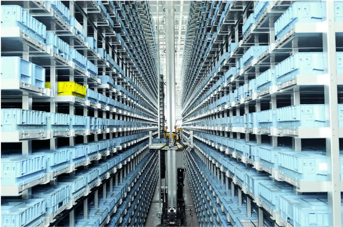
Abb. 16: Regalbediengerät eines automatischen Kleinteilelagers, Quelle: SSI Schäfer AKL (2020), Online-Quelle [16.08.2020]
