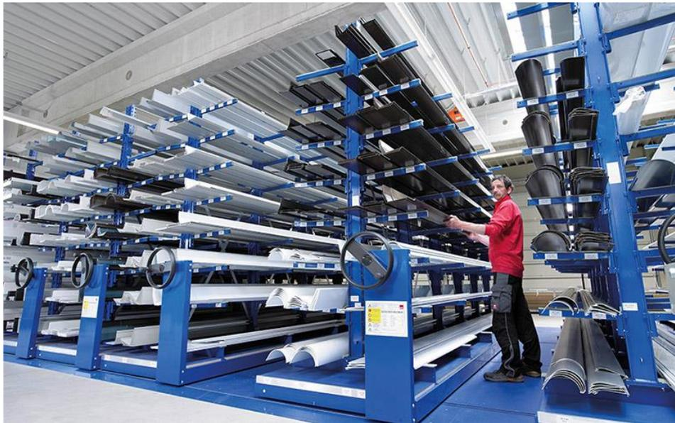
Abb. 21: Mechanisches Verschieberegale, Quelle: Berg Lagertechnik Verschieberegale (2020), Online-Quelle [13.09.2020]
