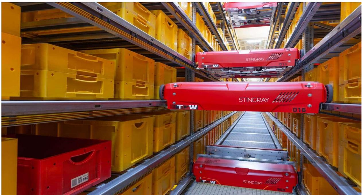
Abb. 17: Shuttlesystem eines automatischen Kleinteilelagers, Quelle: Logistra Shuttle (2020), Online-Quelle [16.08.2020]
