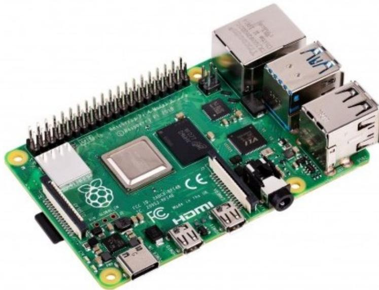
Abb. 4.8: Raspberry Pi 4 Model B, Quelle: Raspberry Pi, Online-Quelle [24.Juli.2020]
