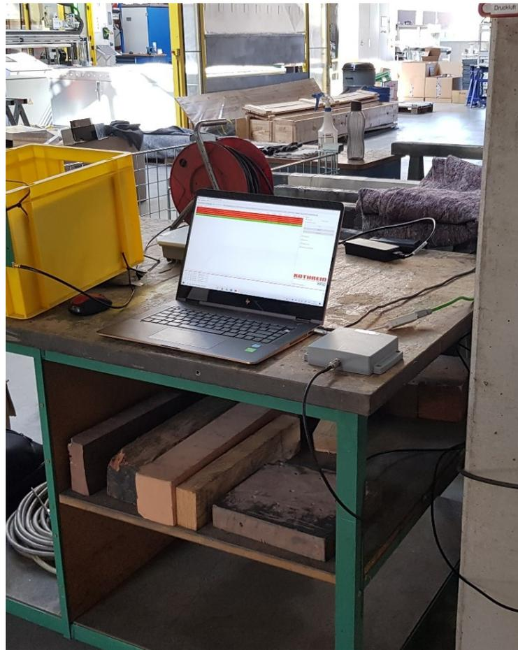
Abb. 42: Low-Range-Antenne zur Übertragung des EPC, Quelle: Eigene Darstellung.
