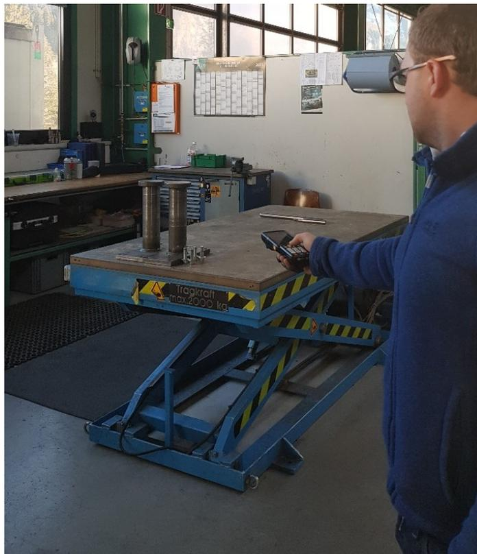
Abb. 30: Bauteilkontrolle mittels mobilem RFID-Reader, Quelle: Eigene Darstellung.
