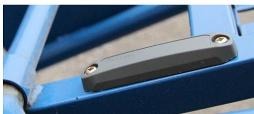
Abb. 29: UHF On-Metal-Transponder, Quelle: Confidex (2017), Online-Quelle [11.11.2020].
