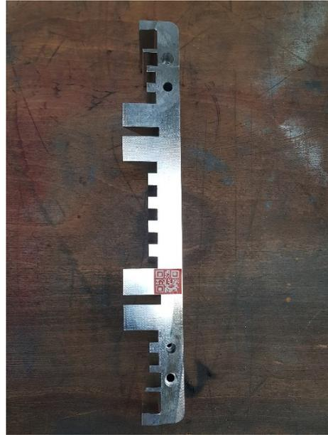
Abb. 34: Klebeetikette befestigt an Fertigungsbauteil, Quelle: Eigene Darstellung.
