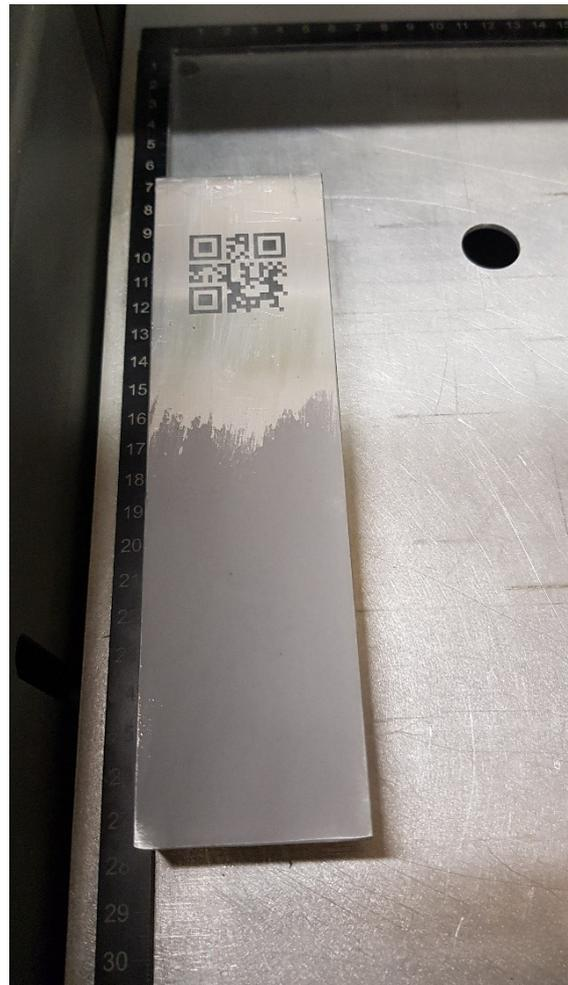
Abb. 39: Teilweise gereinigtes, lasergraviertes Bauteil,
