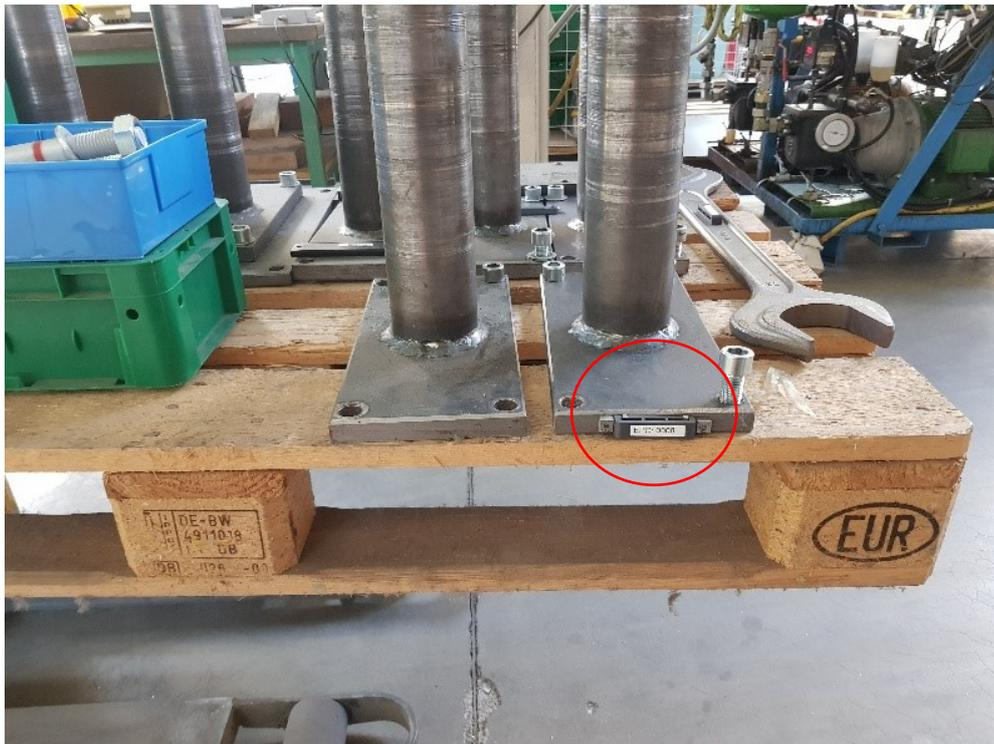
Abb. 41: Anbringung des Transponders an einem metallischen Bauteil, Quelle: Eigene Darstellung.
