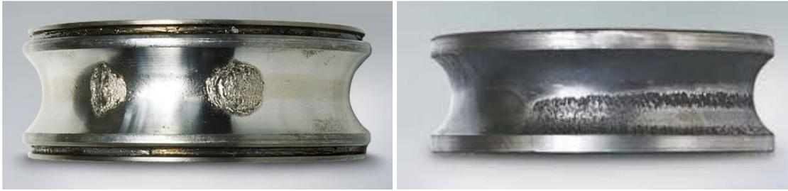
Abb. 3-11: Wälzlagerschäden (Pitting)<sup>35</sup>
