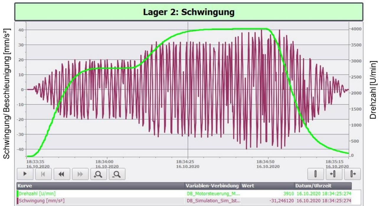
Abb. 7-3: Simulation – Diagramm Schwingungsanalyse
