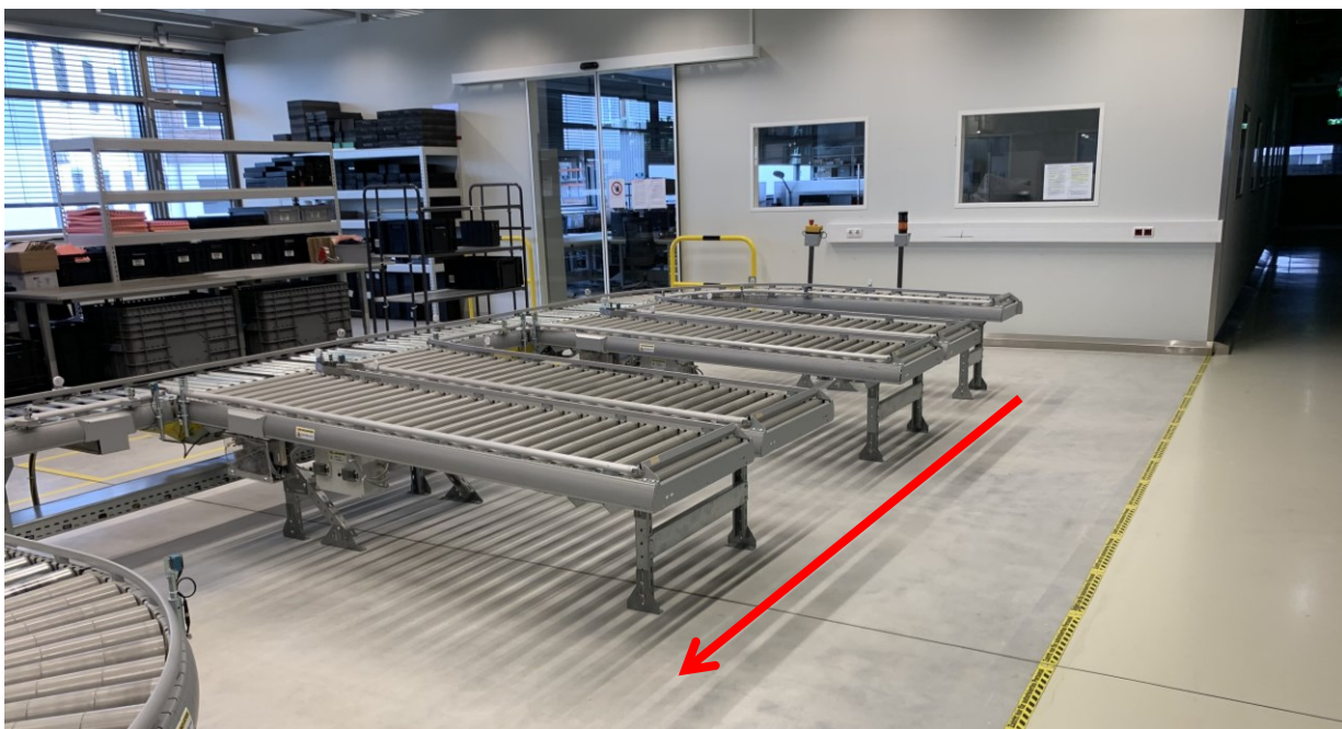
Abb. 48: Aktuelle Auslaufstrecke, die Behälter der Breite nach ausgibt; der Pfeil gibt die Richtung der Komprimierung an, Quelle: Eigene Darstellung.
