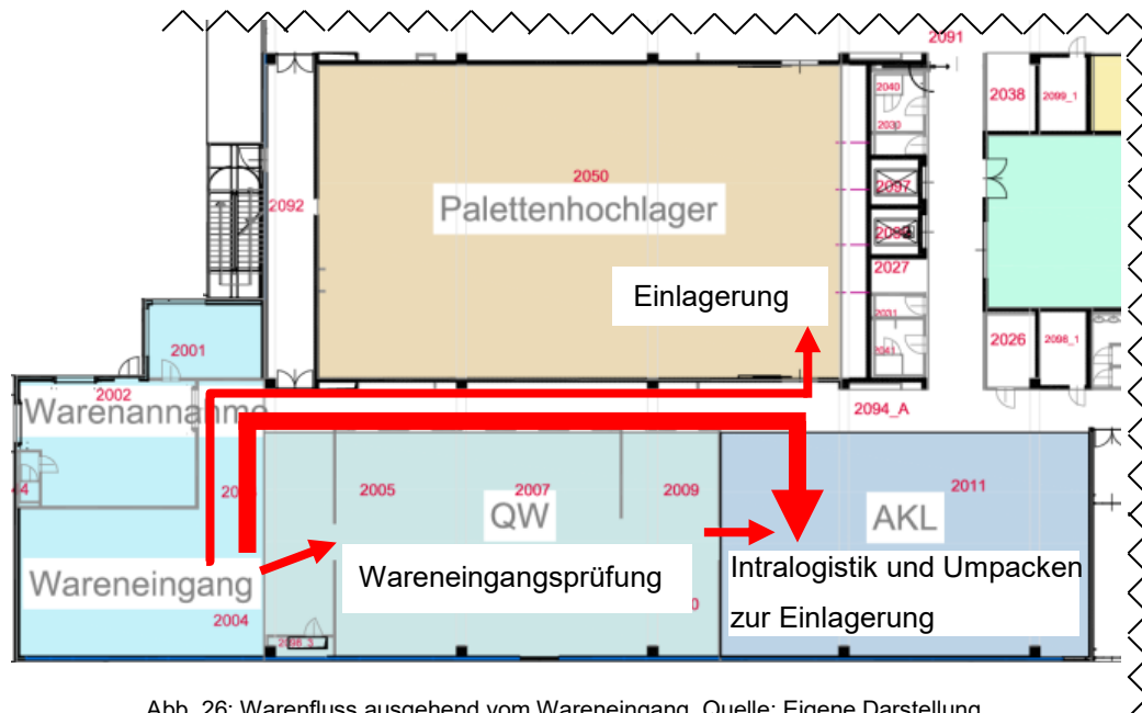
Abb. 26: Warenfluss ausgehend vom Wareneingang, Quelle: Eigene Darstellung.
