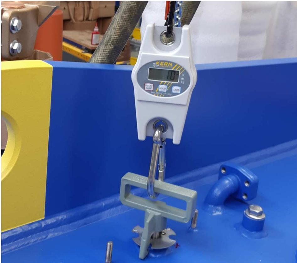
Abb. 14: Versuchsaufbau Vertikal-Kraft-Messung, Quelle: Eigene Darstellung.
