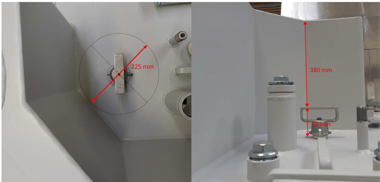
Abb. 16: Einbauposition eines Stufenschalters, Quelle: Eigene Darstellung.
