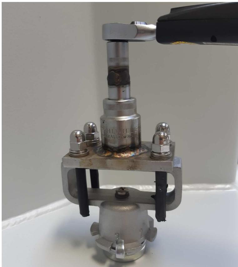
Abb. 15: Versuchsaufbau Drehmomentmessung, Quelle: Eigene Darstellung.
