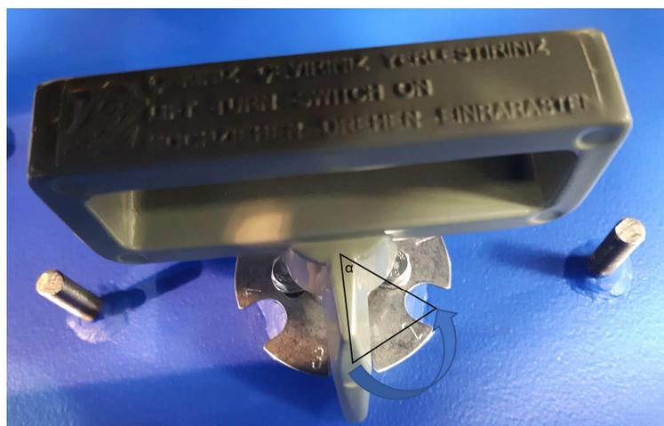
Abb. 22: Schaltwinkel Stufenschalter, Quelle: Eigene Darstellung.
