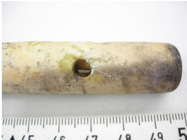
Abbildung 23: Befundbericht SN120325 Sauerstoffsonde von Gießpulver angegriffen thermo-control Körtvélyessy GmbH, Quelle: Körtvélyessy GmbH.
