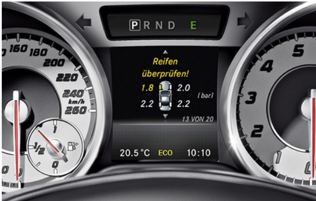
Abbildung 3: Positionszuordnung der Luftdrücke, Quelle: Jordan (2013), Online-Quelle [29.07.2019].
