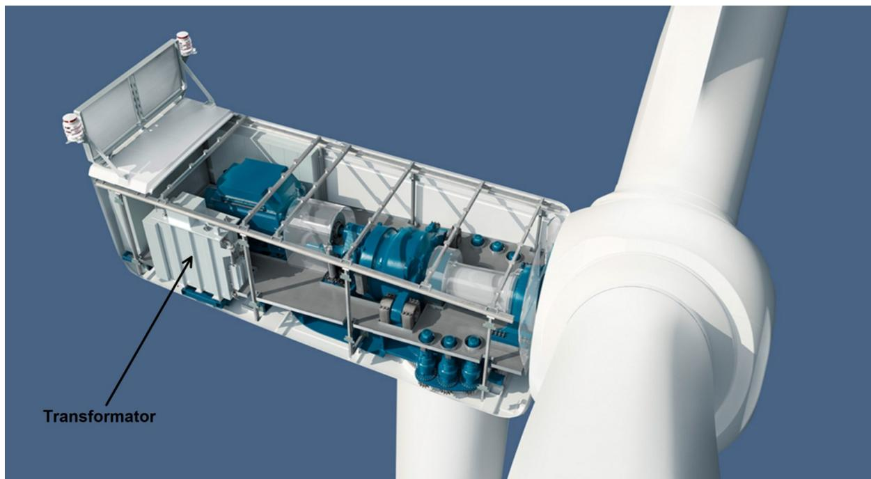
Abb. 22: Gondel-Transformator, Quelle: Nordex SE (2017), Online-Quelle [19.09.2019], (leicht modifiziert).
