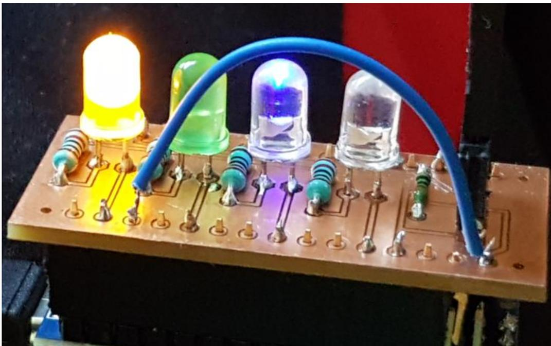
Abb. 39: LED-Board mit einigen angesteuerten LEDs, Quelle: Eigene Darstellung.
