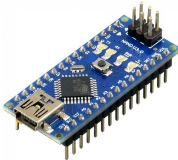
Abb. 25: Arduino Nano-Board V3.0, Quelle: core Electronics (2019), Online-Quelle [01.05.2019].
