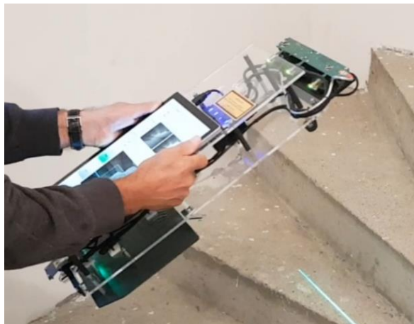
Abbildung 2 Prototyp des Weitzer Treppenscanners, Quelle: Weitzer Parkett Archiv (2018)
