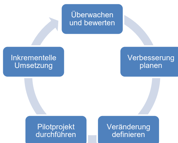
Abbildung 2-6: Verbesserungsprozess für die Einführung von MBSE (in Anlehnung an Friedenthal et al., 2015)
