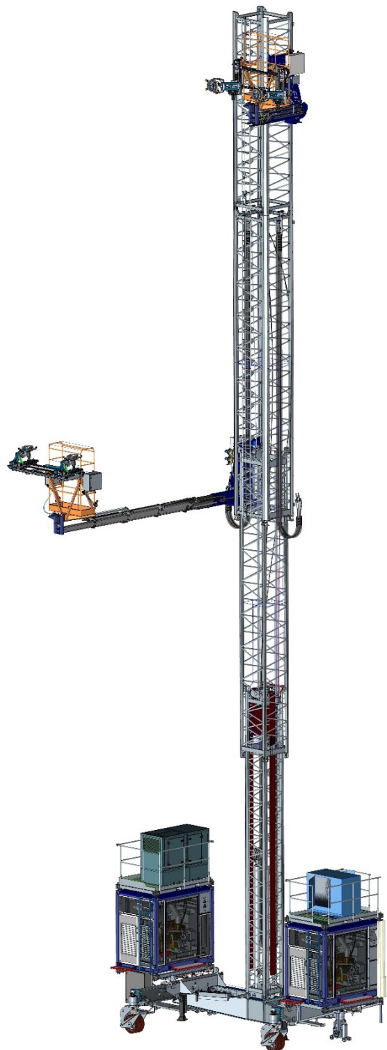
Abbildung 21: Unterwagen mit ausgefahrenem Turm und angeflanschter Turmverlängerung, Quelle: Eigene Darstellung
