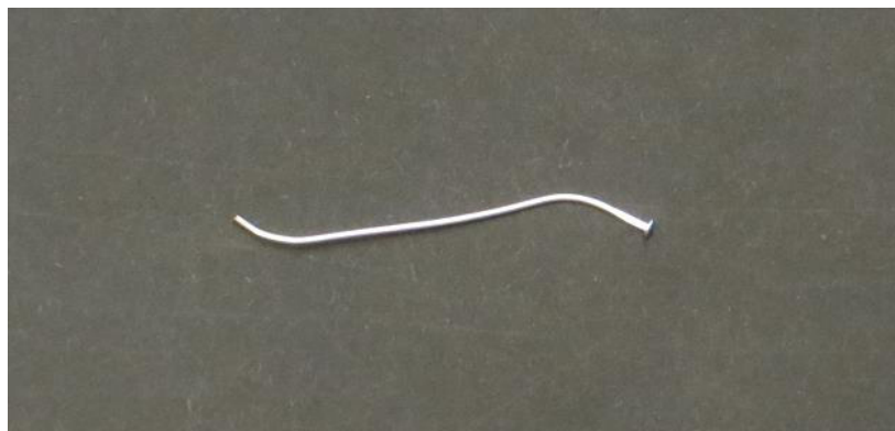
Abb. 48: Charakteristische Verformung der Nietstifte bei zu geringem Matrizenabstand, Quelle: Eigene Darstellung.
