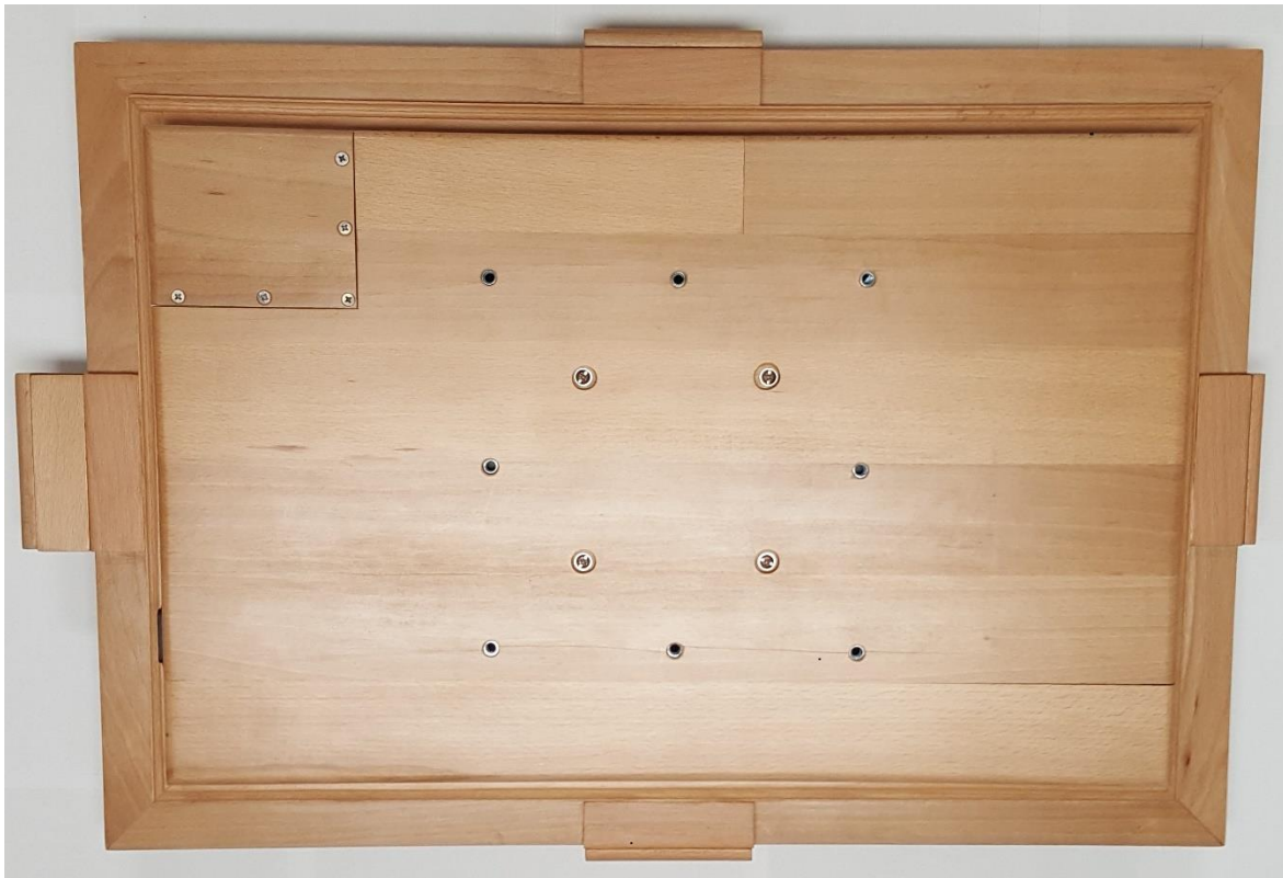
Anhang Abb.8: Gehäuse mit VESA-Befestigungsmöglichkeit, Quelle: Eigene Darstellung.
