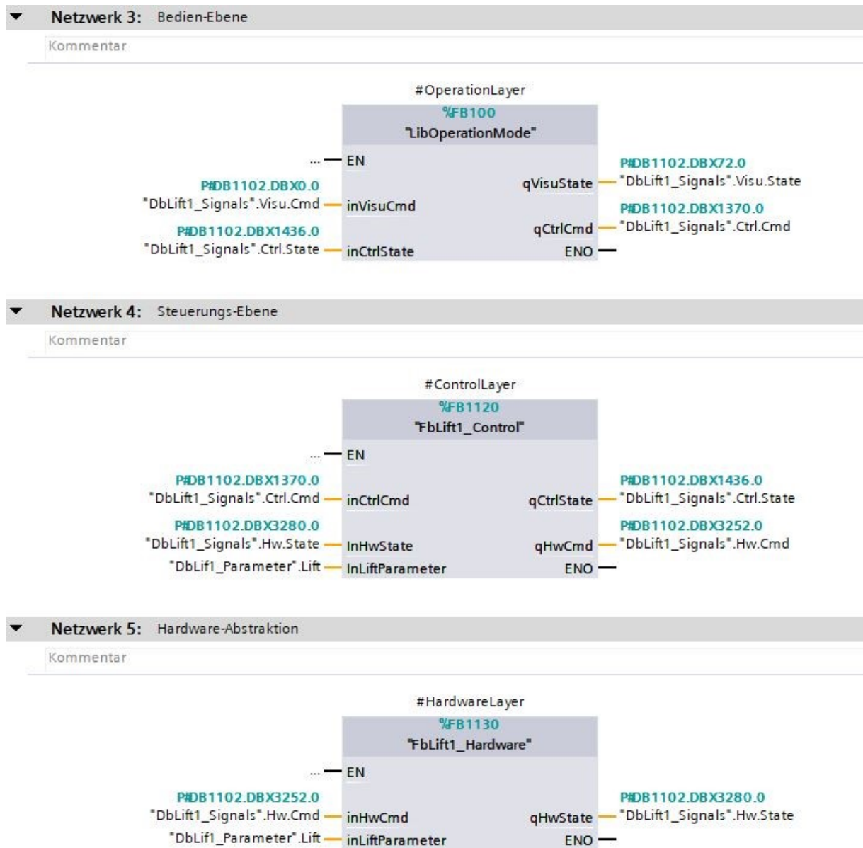
Abbildung 28: Aufrufender Baustein der Liftsteuerung, Quelle: Eigene Darstellung.
