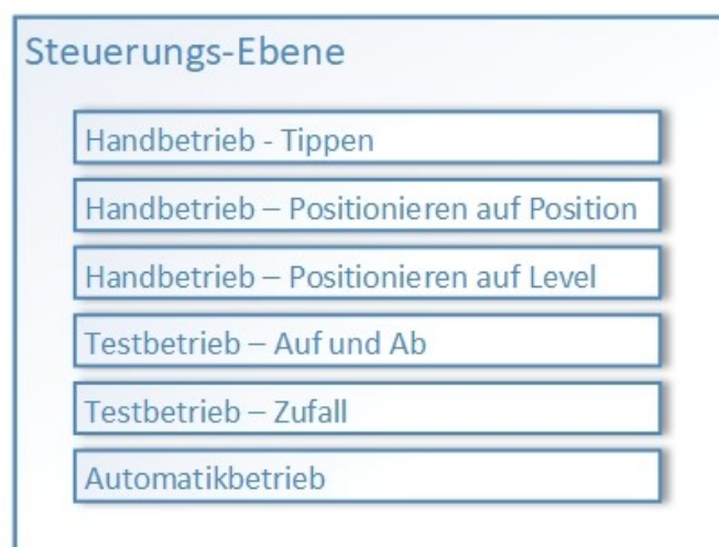
Abbildung 21: Schematischer Aufbau der Steuerungs-Ebene, Quelle: Eigene Darstellung.
