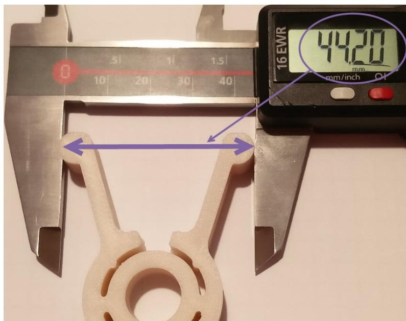
Abb. 65: Messpunkt am Beispiel der Klemmverbindung, Quelle: Eigene Darstellung.
