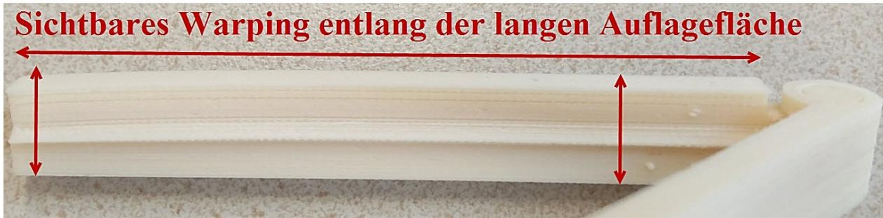
Abb. 68: Sichtbares Warping entlang der langen Auflagefläche an der Clipverbindung, Quelle: Eigene Darstellung.
