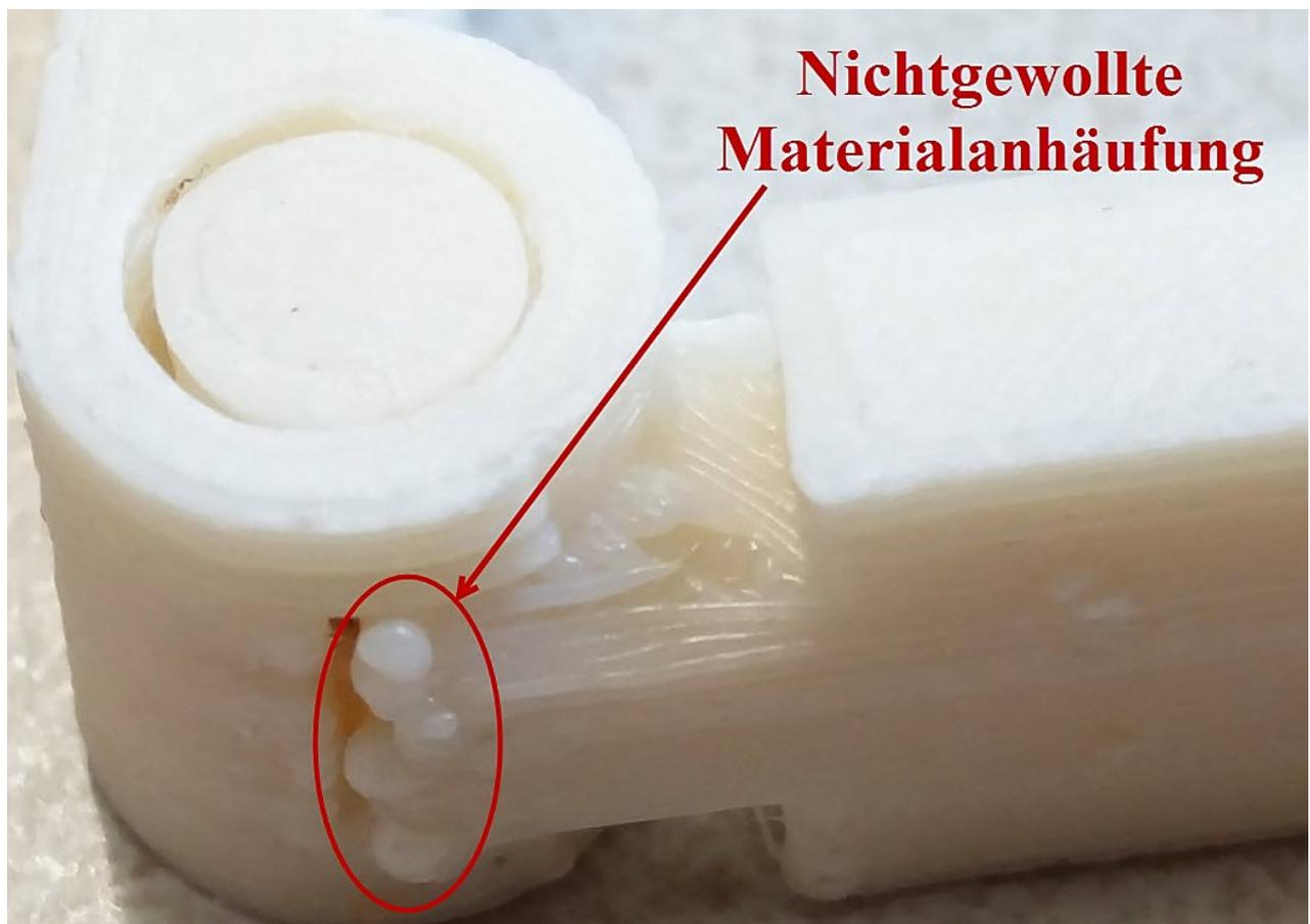
Abb. 67: Nichtgewollte Materialanhäufung direkt am Verbindungselement der Clipverbindung, Quelle: Eigene Darstellung.
