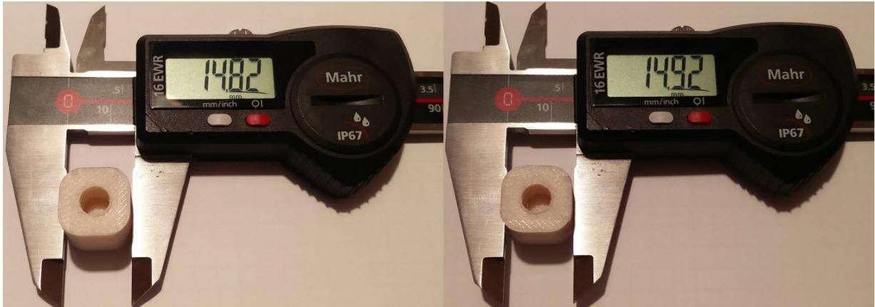
Abb. 59: Messpunkt der Probenkörper in x- und y-Richtung, Quelle: Eigene Darstellung.
