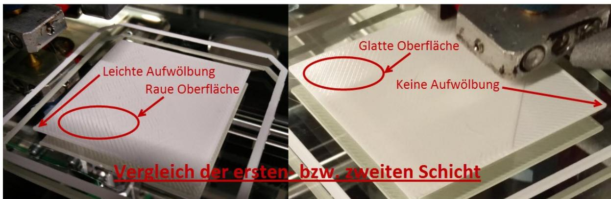
Abb. 10: Schlechte Schichten (links) und optimale Schichten (rechts), Quelle: Eigene Darstellung.
