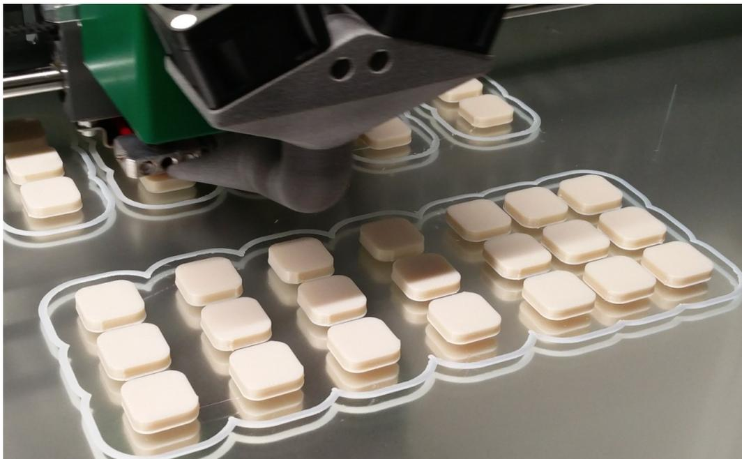
Abb. 37: Generative Fertigung mit dem 3D-Druckermodell HAGE 3D-72L-A, Quelle: Eigene Darstellung.
