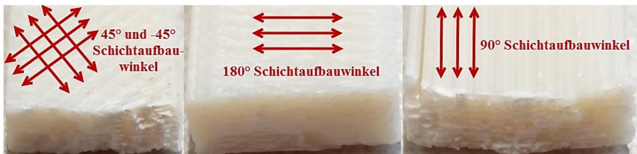
Abb. 53: Darstellung der geprüften Probenkörper mit unterschiedlichen Schichtaufbauwinkeln, Quelle: Eigene Darstellung.
