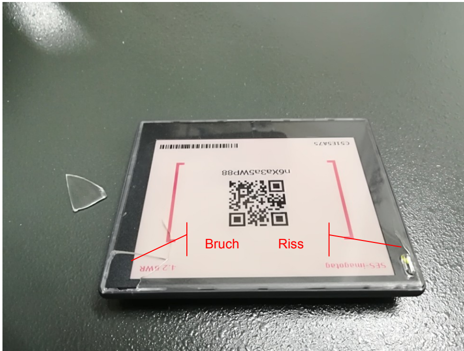
Abb. 60: Gebrochene Abdeckung nach 5 Testvorgängen aus 1200 mm Höhe. Quelle: Eigene Darstellung
