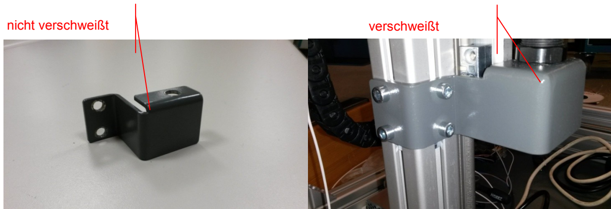
Abb. 47: Befestigungsbleche des Stoßdämpfers. Beide Ausführungen im Vergleich. Quelle: Eigene Darstellung
