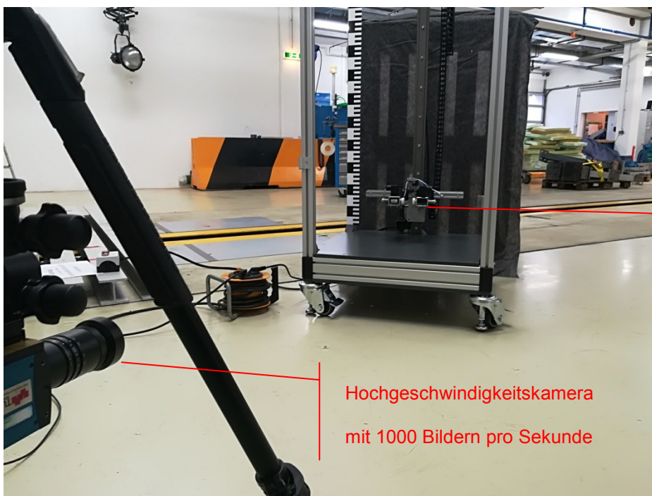
Abb. 53: Aufbau der Hochgeschwindigkeitskamera. Quelle: Eigene Darstellung
