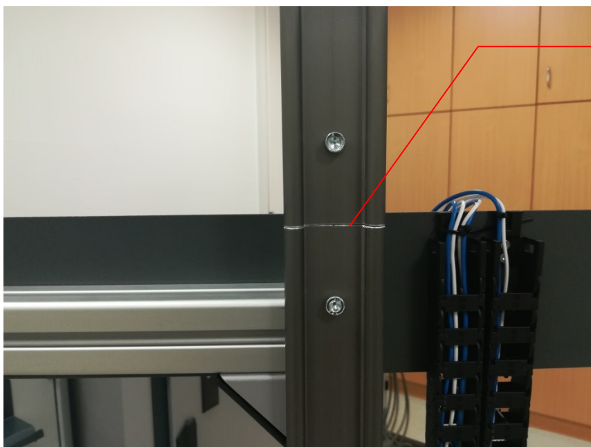
Abb. 38: Bearbeitete Stoßstelle der beiden Führungsschieneiteile. Quelle: Eigene Darstellung
