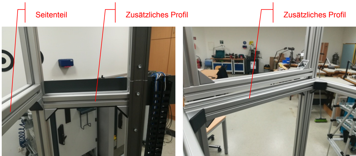
Abb. 37: Zusätzliche Profile um die Stabilität zu erhöhen. Quelle: Eigene Darstellung
