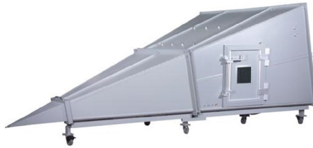
Abb. 1: GTEM-Zelle der FH Campus 02 GmbH, Quelle: ETS-Lindgren (2013), Online-Quelle [28.11.2017], S. 1.
