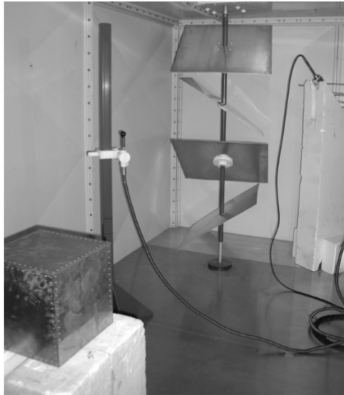
Abb. 20: Innenraum einer Modenverwirbelungskammer, Quelle: Schwab/Kürner (2011), S. 229.
