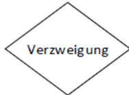
Innerhalb eines Verzweigungssymbols wird eine Bedingung eingetragen nach welcher verzweigt wird. Von dem Verzweigungssymbol gehen Linien aus, auf denen notiert wird, ob die Bedingung erfüllt wurde oder nicht.
