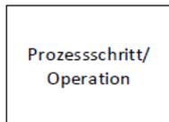
Einzelne Prozessschritte oder Operationen werden als Rechtecke dargestellt. Innerhalb des Rechteckes wird eine möglichst eindeutige, sprachliche Beschreibung des Prozesses eingefügt.
