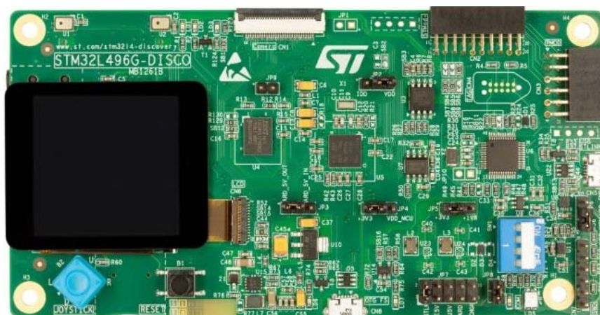
Abbildung 27: Vorderseite 32L496G-DISCOVERY (Modifiziert); Quelle: http://www.mikrozone.sk/obrazky/newspost_images/12.27.19.jpg [Datum 12.09.2017]
