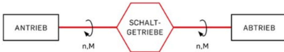
Abbildung 89: Vereinfachter schematischer Aufbau eines Getriebeprüfstandes, Quelle: Kristl, Seibt & Co GmbH (2018), Online-Quelle [5.Juli.2018].
