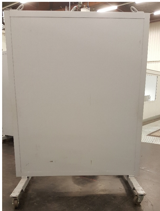
Abbildung 91: Bewegliche Berstsicherungswand, Quelle: Eigene Darstellung.
