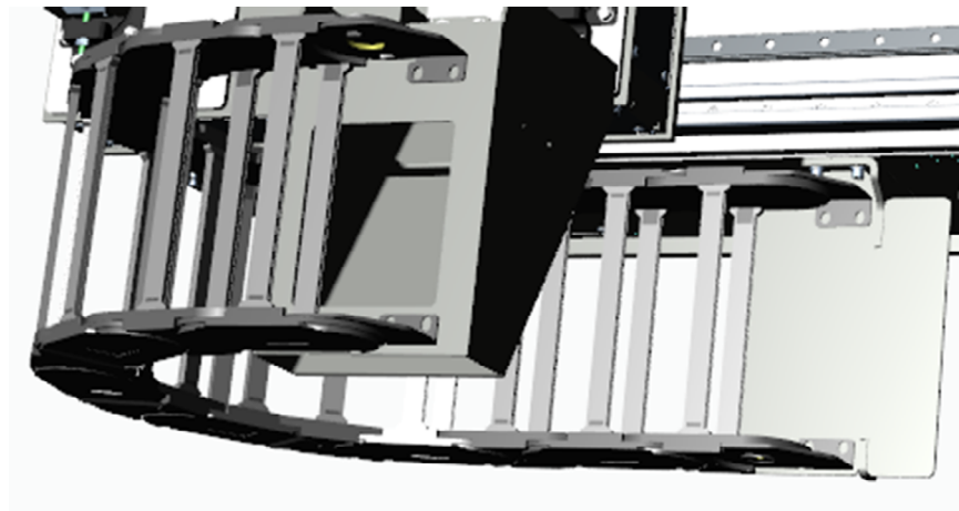
Abbildung 85: Schematische Darstellung einer Schleppkette am Maschinenunterbau, Quelle: Eigene Darstellung.
