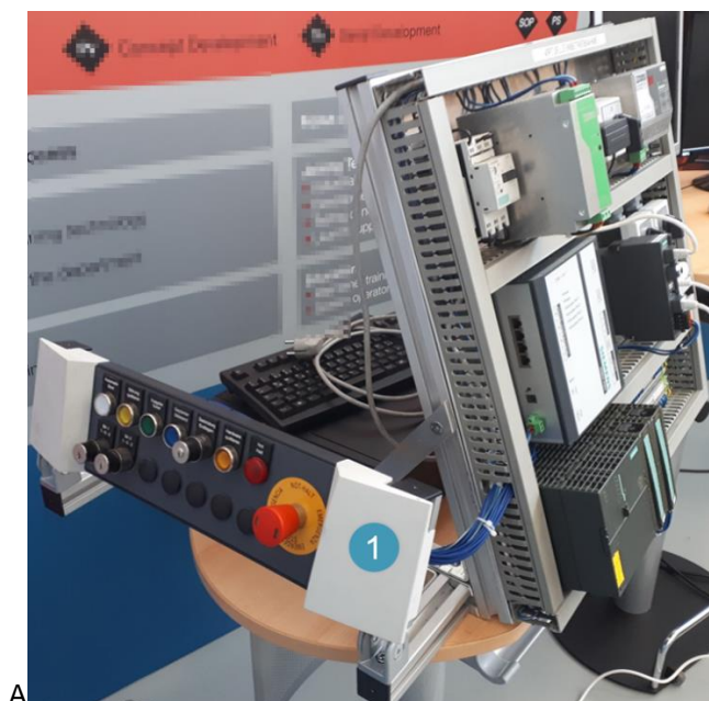
Abb. 47: HiL-Testkit zur Durchführung einer VIBN bei MSF (Seitenansicht), Quelle: Eigene Darstellung.
