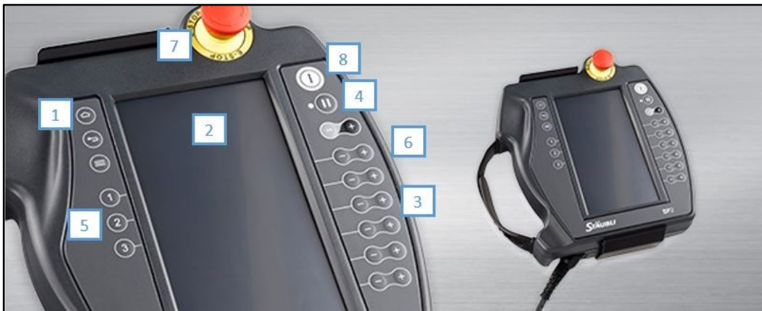
Abb. 30: Programmierhandgerät Stäubli SP2, Quelle: Stäubli (2016), Onlinequelle [01.12.2016].
