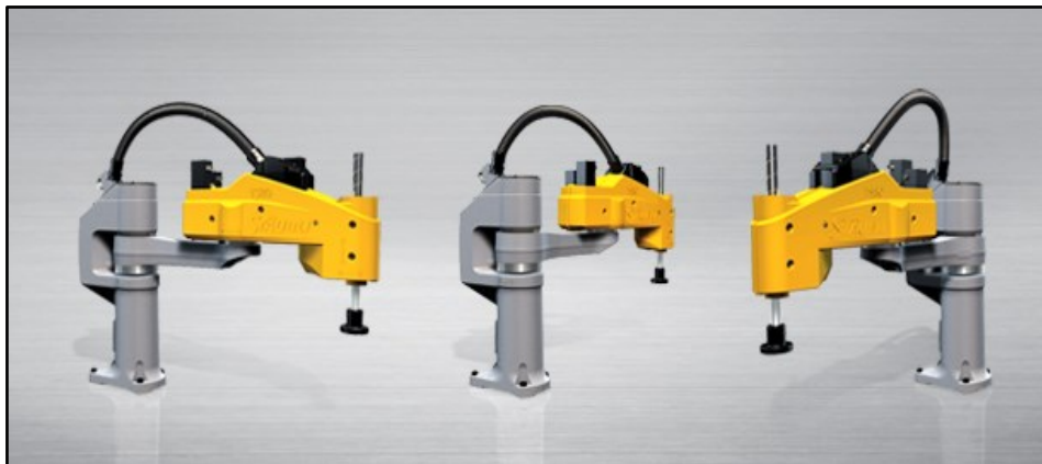
Abb. 16: Beispiel für die Ausführung eines Scara-Roboters, Quelle: Stäubli (2016), Onlinequelle [01.12.2016].
