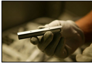
Abb. 44: Manuelle Handhabung der Bauteile nach dem Sandstrahlprozess, Quelle: Eigene Darstellung.
