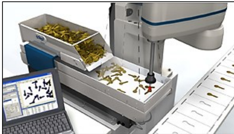
Abb. 10: Darstellung eines Einlegegeräts mit optischer Teilerkennung, Quelle: Robini Hannover (2016), Onlinequelle [01.12.2016].
