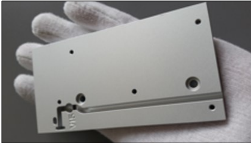
Abb. 50: Bearbeitetes Bauteil nach dem Sandstrahlprozess, Quelle: Eigene Darstellung.
