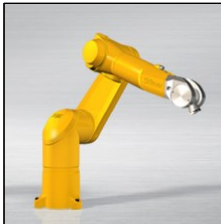
Abb. 57: Industrieroboter Stäubli TX60L CS8C, Quelle: Stäubli (2016), Onlinequelle [01.12.2016].
