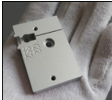
Abb. 46: Gewünschtes Oberflächenergebnis nach dem Sandstrahlprozess, Quelle: Eigene Darstellung.
