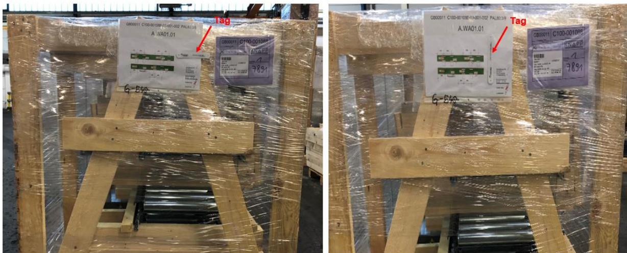
Abb. 37: Transponder links in waagrechter und rechts in vertikaler Ausrichtung, Quelle: Eigene Darstellung.
