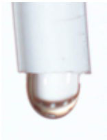
Abbildung 33: Entstehung eines Tropfens beim Auslassschlauch
