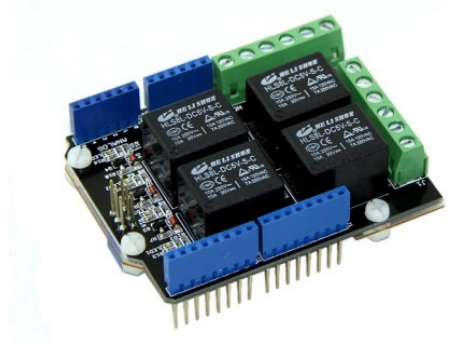
Abbildung 13: Arduino UNO mit einem Relais Shield.
