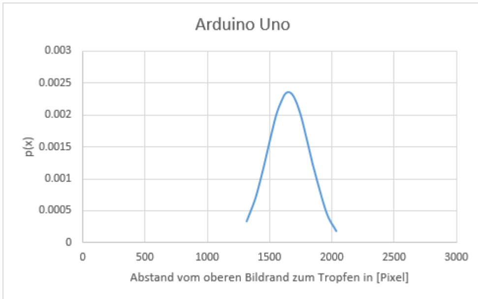
Abbildung 36: Normalverteilung der absoluten Tropfenposition auf dem Bild für den Arduino.
