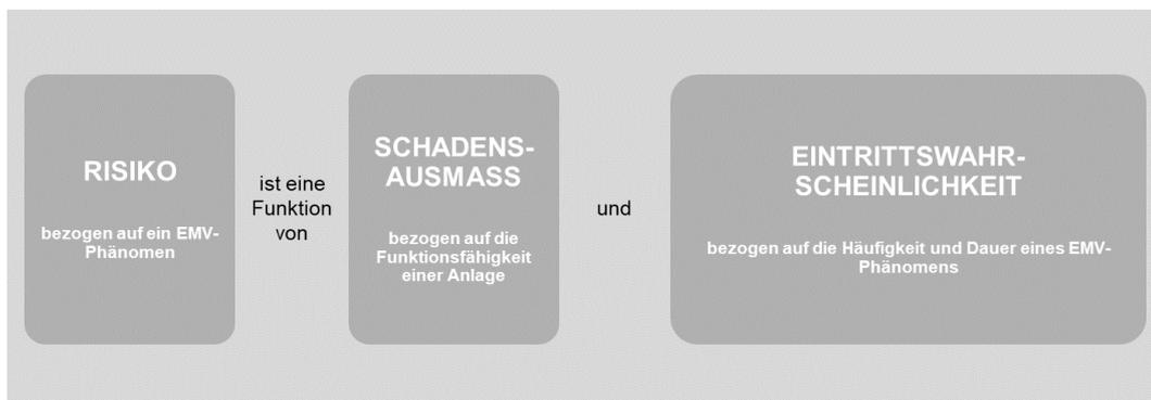
Abb. 36: Risikoelemente nach EN ISO 12100 angepasst an die EMV-Richtlinie, Quelle: Eigene Darstellung.
