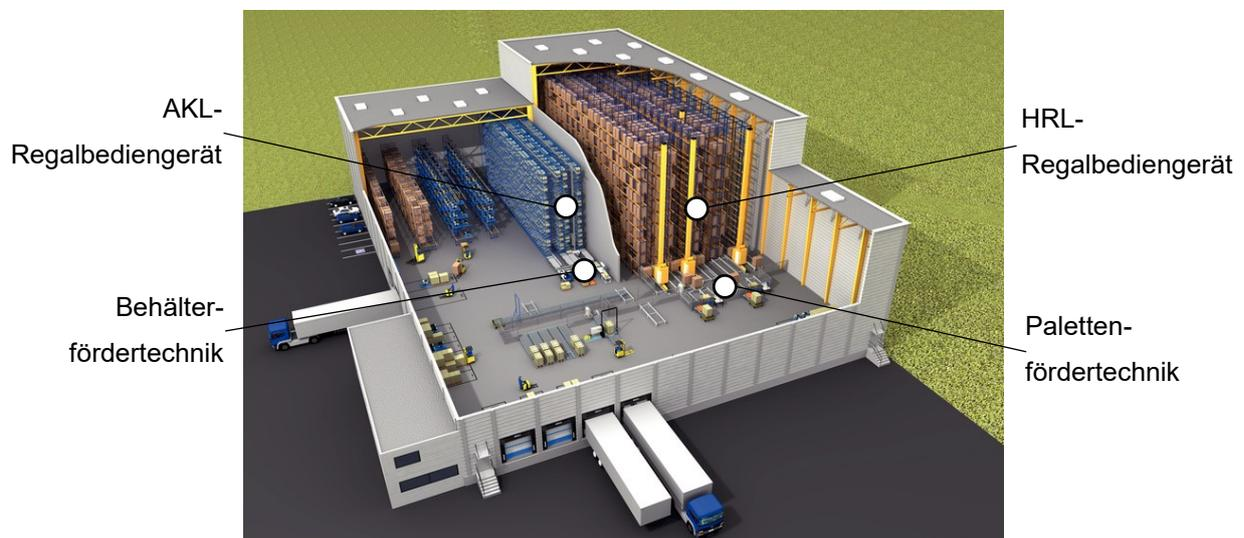
Abb. 2: Übersicht der Elemente einer Logistikanlage, Quelle: Jungheinrich AG - 2 (2018), Online-Quelle [01.10.2018] (leicht modifiziert).
