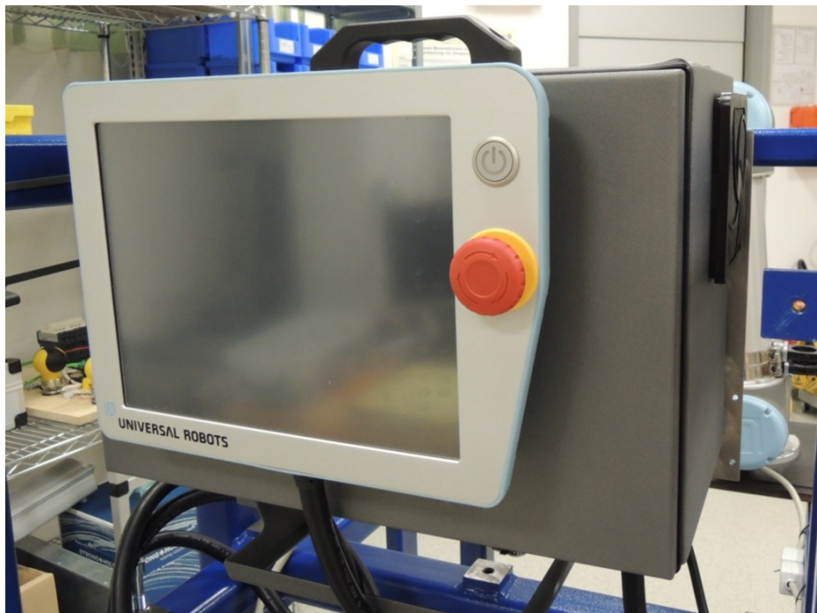
Abb. 27: Befestigung der Robotersteuerung am Aufbau, Quelle: Eigene Darstellung
