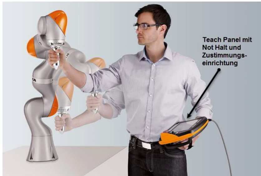
Abb. 4: Teaching eines Roboterarmes am Kuka LBR iiwa, Quelle: KUKA AG (2017), Online-Quelle [06.05.2017] (leicht modifiziert).
