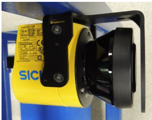
Abb. 19: Sicherheitslaserscanner Typ S300-Expert der Firma Sick inklusive Montagebügel, Quelle: Eigene Darstellung
