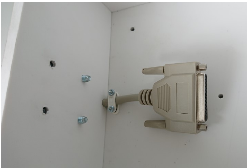
Abb. 47: Verbindung von Prüfgerät und Anschlussbox über D-SUB-Leitung, Quelle: Eigene Darstellung
