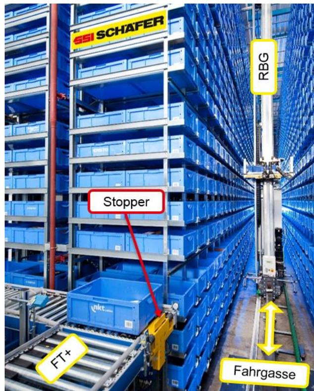
Abb. 33: Lagersystem SCHÄFER Miniload Crane, Quelle: SSI SCHÄFER Automation GmbH.
