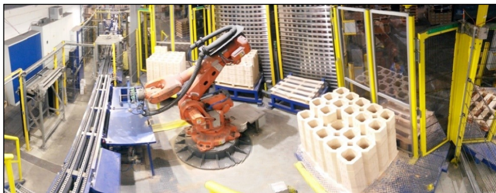
Abbildung 26: Anwendung 2, Auftragsreines Palettieren der Produkte, Quelle: eigene Darstellung.
