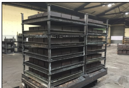
Abbildung 39: Beispielhafte Darstellung von aufeinandergestapelten, einlagig beschichteten Stahlpaletten mit Stützen, Quelle: eigene Darstellung.
