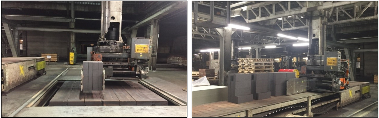
Abbildung 32: Ausgangssituation - Entladen der Tunnelofenwägen mittels Manipulator, Quelle: eigene Darstellung.
