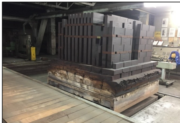
Abbildung 31: Ausgangssituation - Bereitstellung der beladenen Tunnelofenwägen, Quelle: eigene Darstellung.
