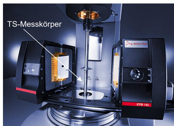
Abb. 22: MCR 702 TwinDrive, zu entwickelnder TS-Messkörper und Temperierkammer, Quelle: Anton Paar GmbH (2017), Online-Quelle [16.10.2017] (leicht modifiziert).
