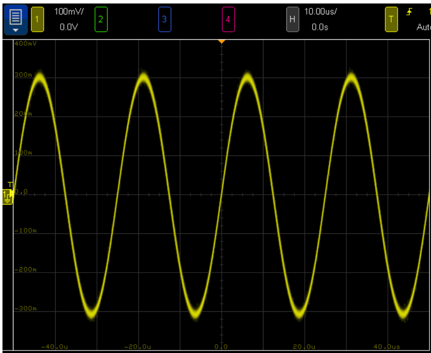
Abb. 19: Empfangssignal der Übertragung zweier Ultraschallsensoren vom Typ 400PT16P mit 40 kHz Sendesignal, Quelle: Eigene Darstellung.
