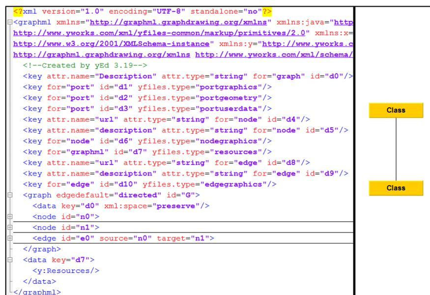
Abbildung 49: Darstellung eines simplen Graphen als GraphML-File (links) und in grafischer Darstellung (rechts), Quelle: Eigene Darstellung
