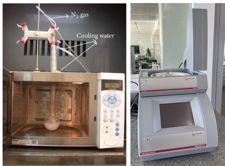
Abbildung 5: Haushaltsmikrowelle (links) vs. Kommerzielle Labormikrowelle (rechts) in der chemischen Synthese, Quelle: links: Ha/Canh/Tuyen (2013), S. 2; rechts: Eigene Darstellung.
