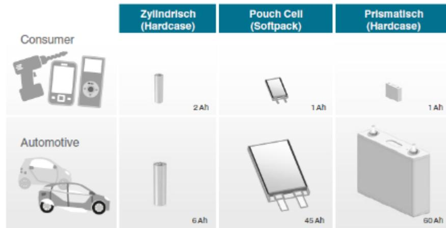
Abbildung 7: Verschiedene Zelltypen und Anwendungsmöglichkeiten, Quelle: Wöhrle (2013) S. 112.
