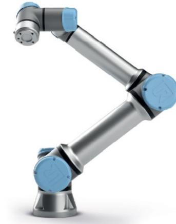
Abbildung 62: Cobot UR5e des Herstellers Universal Robots, Quelle: JUGARD+KÜNSTNER GmbH (n. a.), Online-Quelle [24.November.2018] S. 1.
