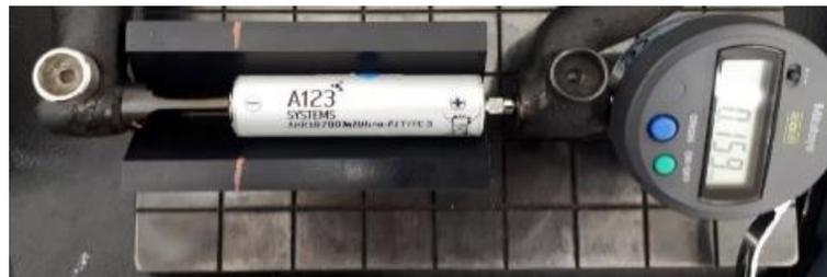
Abbildung 24: Digitale Messuhr zum Messen der Zelllänge, Quelle: Eigene Darstellung.
