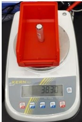
Abbildung 25: Präzisionswaage zur Gewichtsmessung der Batteriezelle, Quelle: Eigene Darstellung.
