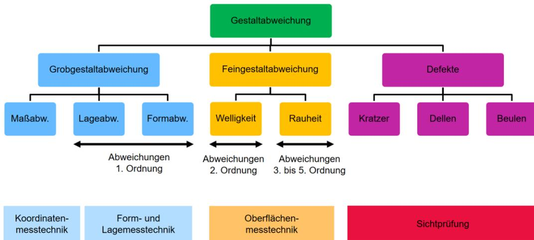
Abbildung 41: Ordnungssystem für Gestaltabweichung an Werkstücken, Quelle: Keferstein/Marxer/Bach (2018) S. 95 (leicht modifiziert).
