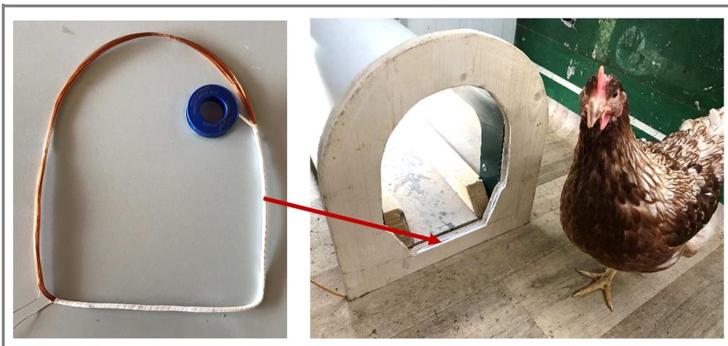
Abbildung 50: Links: Gewickelte Durchgangsantenne, Rechts: Antenne eingefasst in einem Holzrahmen, Quelle: Eigene Darstellung.
