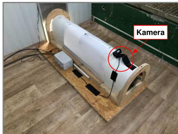
Abbildung 69: Kamera mittig am Tunnel angebracht, Quelle: Eigene Darstellung.
