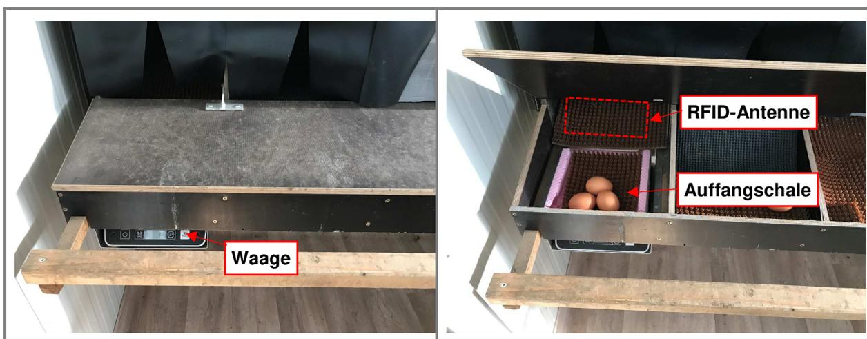
Abbildung 64: Legenest mit RFID-Lesegerät und integrierter Waage, Quelle: Eigene Darstellung.
