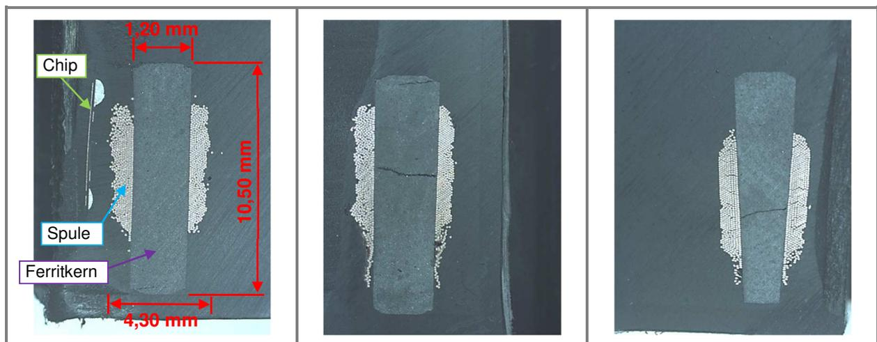
Abbildung 52: Schliffbilder von vergossenen Transpondern im Geflügelring, Quelle: Eigene Darstellung.
