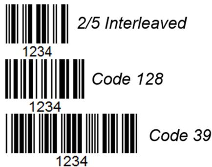
Abbildung 25: Größenvergleich der Strichcodes 2/5 Interleaved, Code 128 und Code 39, Quelle: Eigene Darstellung.
